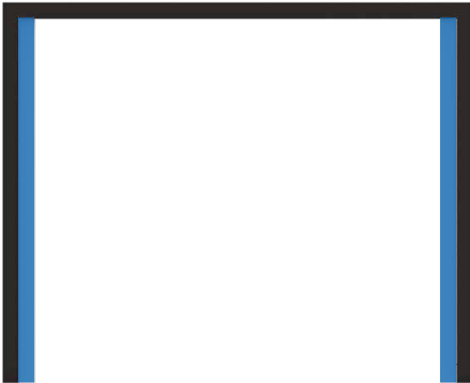
2-seitiger Blendrahmen ohne Abdeckprofil. Bei dieser Option wird der Blendrahmen ohne seitlichen Abdeckprofil links und rechts geliefert.
