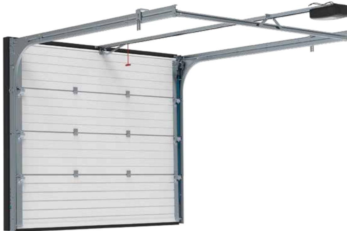
Das TS100 ist ein Schienensystem, das, wie das G100, einen Sturzfreiraum von 100 mm benötigt, aber mit Zugfedern anstelle von Torsionsfedern ausgestattet ist. Die Zugfedern sind in den vertikalen Schienen angebracht. Dank der vorgespannten Federn ist eine schnelle Montage dieses Systems gewährleistet.
