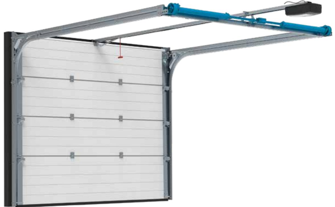
Das R60 ist ein Schienensystem, das sich als Ersatz oder praktische Alternative zu einem alten, ungedämmten Schwingtor eignet. Bauliche Anpassungen sind bei diesem System nahezu überflüssig. Das R60 benötigt einen Sturzfreiraum von lediglich 60 mm und kann nur elektrisch betrieben werden. Die Torsionsfedern sind am Ende der Horizontalschiene angebracht.
