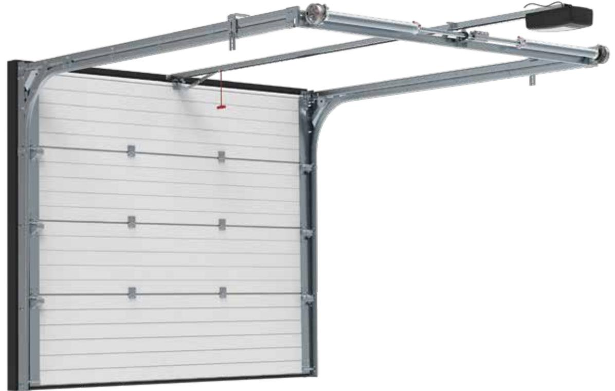
Unser Schienensystem G100 ist die richtige Wahl, wenn die Einbauhöhe begrenzt ist. Das System benötigt einen Sturzfreiraum von 100 mm. Die Torsionsfedern sind am Ende der Horizontalschiene angebracht.
