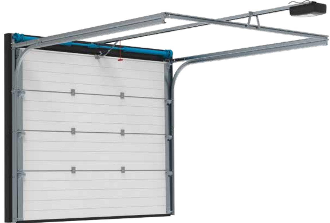
Das G200 ist ein serienmäßiges Schienensystem für Garagentore, das einen Sturzfreiraum von 200 mm benötigt. Die Torsionsfedern sind direkt über dem Tor angebracht.
